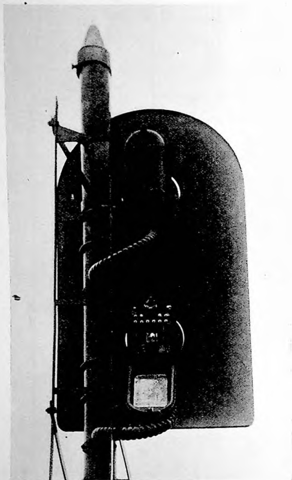
Afb. 42. Gecombineerd hoofd- en voorsein. (Achterdeksel voorsein geopend).
